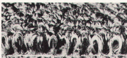
Der strapazierfähige Flor im Querschnitt
