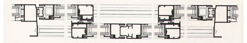
Die Möglichkeit ALUSUISSE-Legierungen durch Strangpressen auf wirtschaftliche Weise zu Profilen verschiedenartigster Querschnitte zu verformen, hat dem Aluminium eine weite Verbreitung im Fensterbau gebracht. ALUSUISSE-Spezialprofile erlauben vollkommene konstruktive Lösungen, einwandfreie ästhetische Formen und Ersparnisse an Material und Bearbeitungskosten. Für Fenster der verschiedensten Arten sind eine grosse Zahl interessanter Profilserien entwickelt worden.
