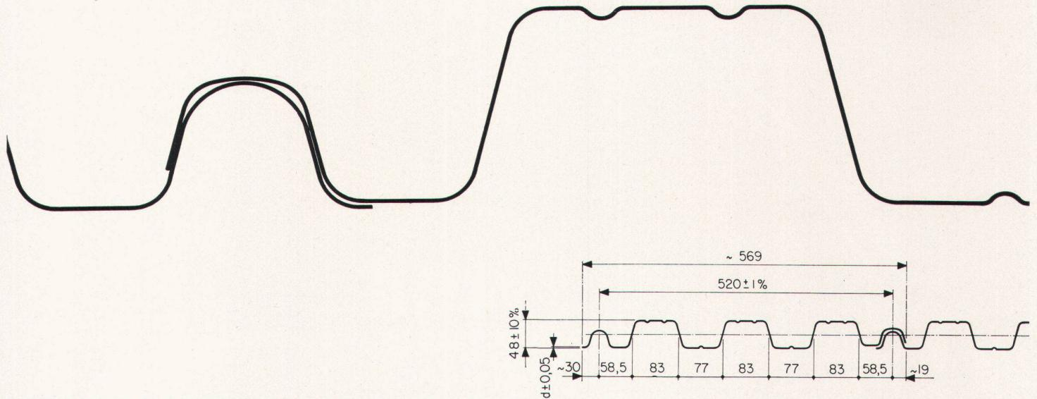
Lange Wellbänder aus Aluman – blank oder alodinebehandelt – sind eine ALUSUISSE-Spezialität. Damit können z. B. Fassaden von Industriebauten und Hallen aller Art fugenlos, d. h. ohne die sonst üblichen, unliebsamen horizontalen Überlappungen verkleidet werden. Unsere Fassaden-Wellbänder können mit verschiedenartigen Wellungen in einer Reihe von Farben einbrennlackiert geliefert werden.
