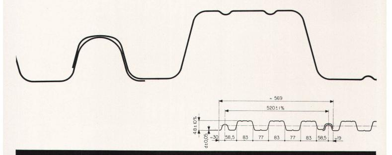
Lange Wellbänder aus Aluman — blank oder alodinebehandelt — sind eine ALUSUISSE-Spezialität. Damit können z. B. Fassaden von Industriebauten und Hallen aller Art fugenlos, d. h. ohne die sonst üblichen, unliebsamen horizontalen Überlappungen verkleidet werden. Uberer Fassaden-Wellbänder können mit verschiedenartigen Wellungen in einer Reihe von Farben einbrennlackiert geliefert werden.
