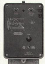
Der einfache Heizungsregler «Equitherm-Junior», mit Transistorverstärker wird vor allem in kleinen bis mittleren Heizanlagen verwendet
