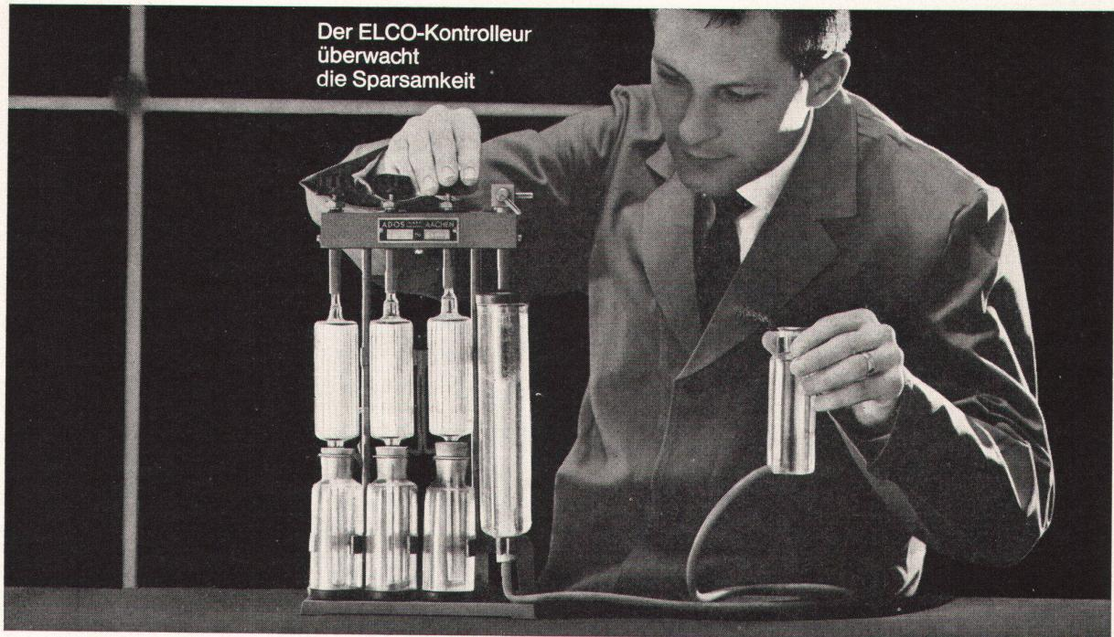
Bevor ein ELCO-Oelbrenner das Werk verlässt, wird er im Prüfstand einer exakten Schlusskontrolle unterzogen. Eine Phase daraus sehen Sie auf dem Bild! Die Rauchgas-Analyse mit dem CO-Prüfgerät. Damit wird der ELCO-Brenner auf sparsamste Verbrennung einreguliert. — Die Schlusskontrolle gibt Ihnen und uns
