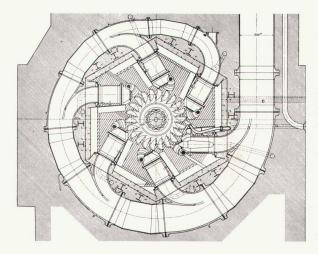
20 Beispiel einer Form der Symmetriegruppe  $C_6$  aus dem Gebiet der Technik. Das Wort «Dreh»-Symmetrie gewinnt hier eine zusätzliche Bedeutung, geht es doch tatsächlich um die Drehung des Turbinenlaufrades. Freistrahlturbine der Firma J. M. Voith, GmbH, Heidenheim (aus: Schweizerische Bauzeitung, 17. August 1961)
