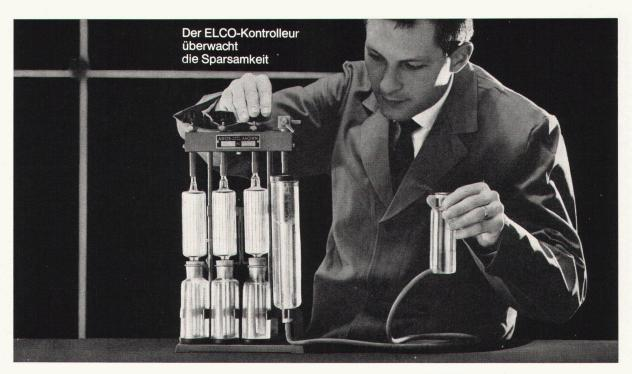
Die Rauchgas-Analyse mit dem CO<sub>2</sub>-Prüfgerät. Damit wird der ELCO-Brenner auf
