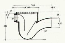
Eintauchzylinder (Geruchverschluß) mit Gummiringdichtung (alterungsbeständig)
