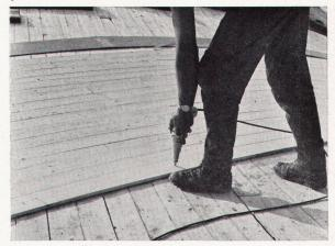
4 Modell 1:10 des Daches im Laboratorium des Ingenieurs; jedes Brett ist maßstäblich nachgebildet Maquette 1:10 de la toiture dans le laboratoire de l'ingénieur; chaque planche est reproduite à l'échelle Model of the roof in the engineer's laboratory. Every board is reproduced exactly to scale
