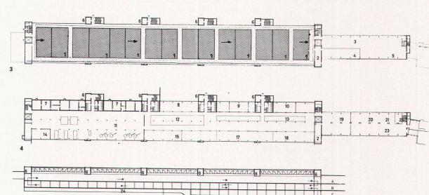
montiert werden. Alle 36 m befindet sich ein vorgespannter Hohlkastenträger, der neben seiner statischen Funktion als Klimakammer beziehungsweise Klimaschacht Verwendung findet. Die Shed-Fachwerkträger sind in diese Hohlkastenträger eingehängt. Die stützenlose Stahlkonstruktion des Geschosses A machte die Anbringung eines Laufkrans (1000 kg) möglich, der die gesamte Fabrikationsfläche zum raschen Auswechseln von Maschinen bestreicht.
