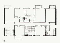
Wohnbauten in Växjö, 1955. Architekt: Ralph Erskine, Drottningholm. Wohnhaus in vorgefertigten Betonelementen; die Aufteilung der Fassaden in Tragwand, Isolationsschicht und Außenhaut ist bis zur letzten Konsequenz durchgearbeitet: um Unterbrüche in der Isolierschicht zu vermeiden (Kältebrücken), sind die Balkone an Kragarmen frei aufgehängt
