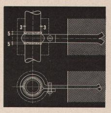
Isolierung von Rohrbefestigungen mit Korkstreifeneinlagen
