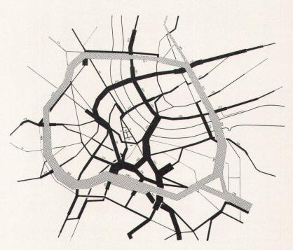
Verkehrsbelastung der beiden projektierten Basler Ringstraßen. Prognose der Fachverbände auf Grund der Umlegung
