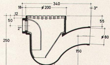
**Gehäuse** mit Auslauf von 80 mm
