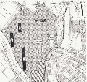
. Situationsplan. Die fünfgeschossigen Häuser werden nach dem System IGECO errichtet werden (vgl. WERK 5/1961, S. 171); auch für die Hochhäuser empfiehlt der Stadtrat vorfabrizierte Bauweise Situation 1:5000
