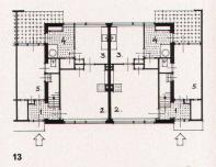
9, 10 Reiheneinfamilienhäuser. Erdgeschoß 1:300, Ostfassade. Architekt: W. van Bodegraven Maisons pour une famille, disposées en série, rez-de-chaussée et face
