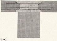
quin de pose, la construction est autostable pendant le montage et ne nécessite aucun étayage ni échafaudage. L'intérêt réside surtout dans le cas de préfabrication lourde où l'on assemble des éléments en béton préfabriqué d'un poids unitaire variant de 5 à 10 t.
