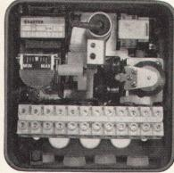
Der Mittelpunkt der Steuereinrichtung ist der Ölfeuerungsautomat. Der abgebildete Typ OTFK 5, für intermittierende oder Dauerzündung, zeichnet sich durch seine kleinen Abmessungen und die robusten Bauelemente aus. Die kurze Reaktionszeit des verstärkerlosen Flammenwächters gewährleistet eine hohe Betriebssicherheit Katalog K 1, Blatt 5
