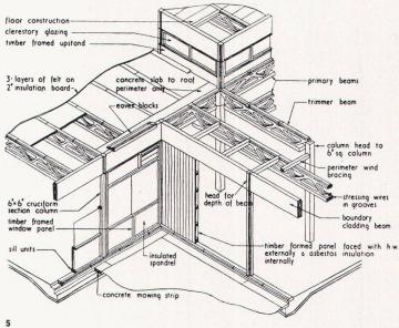
Normierte Deckenträger in Stahl für Schulhausbauten Poutres de plafond en acier normalisées, pour constructions scolaires Standardised steel ceiling beams for schoolhouses
