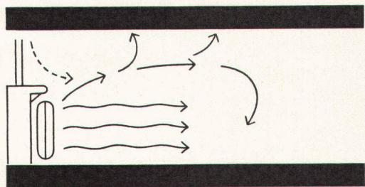
1. Die Fensterkälte, die sinken möchte, wird von der Radiatorenwärme, die steigen möchte, aufgefangen. Der entstehende Wärmestrom verteilt sich gleichmäßig im Raum.
