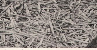
Format 50/200 cm; mittl. Wärmeleitzahl  $\lambda = 0.061$ Stärken 1, 2, 2<sup>1</sup>/<sub>2</sub>, 3<sup>1</sup>/<sub>2</sub>, 5, 7<sup>1</sup>/<sub>2</sub> und 10 cm; zementgebunden
