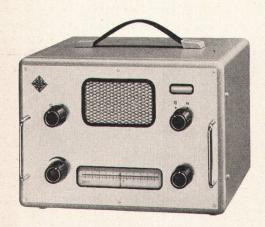
das Mikroport besteht aus: Empfänger ELA T 200 mit Bandantenne; Miniatursender SK 1002, dyn. Handmikrophon; MD 406 mit Nierencharakteristik (auf Wunsch mit Knopflochmikrophon)
