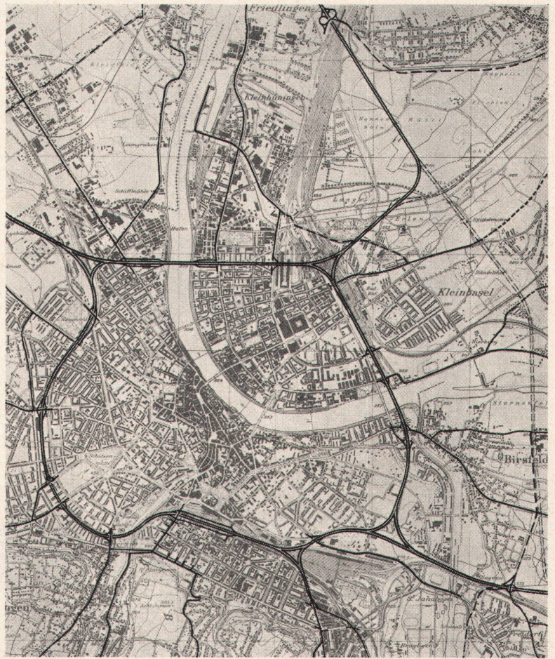
1 Expreßstraßenring um Basel, nach dem Vorschlag der Basler Fachverbände, noch ohne Angaben über die innerstädtische Straßenführung
