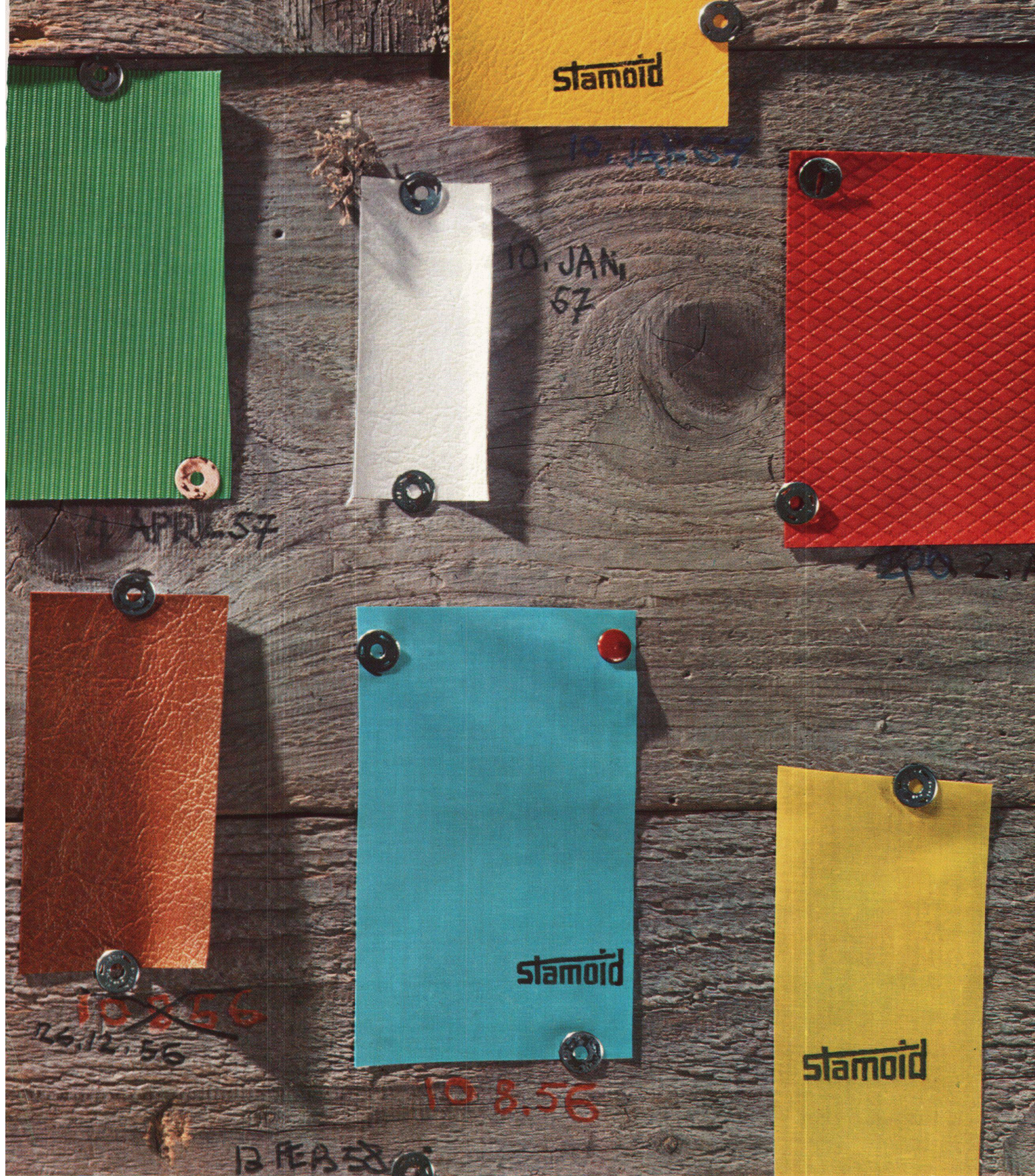
Die Lichtprobe Von Januar bis Dezember werden auf 1800 m ü. M. die Stamoid-Proben dem ultravioletten Berglicht ausgesetzt. Die positiven Ergebnisse unserer Versuche ermutigen, die schönen Stamoid-Farben überall einzusetzen – selbst dort, wo manches andere Material verblassen müsste. Auskunft und Kollektionen: Stamm & Co., Eglisau
