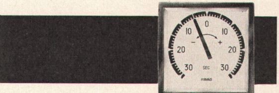
In einem Kraftwerk überwacht die **FAVAG**-Frequenzkontrolluhr die Regelmässigkeit der Frequenz.
