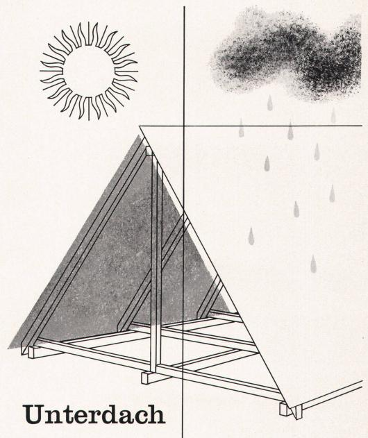
Die auf den Sparren verlegten Platten bilden ein Unterdach, welches besten Schutz vor eindringender Nässe, Flugschnee, Staub sowie Feuerübergriff gewährleistet. Die grossformatigen und leichten Platten gestatten eine ein-
