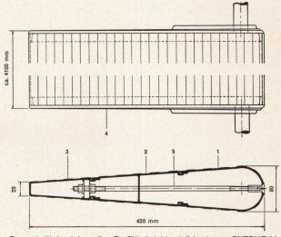
Querschnitt durch Lamellen-Profil in Leichtmetall-Legierung EXTRUDAL
