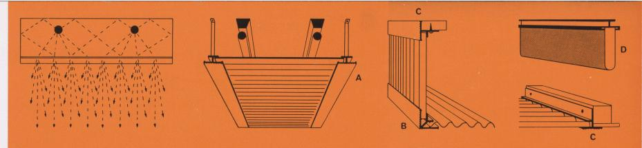
Das durch die Lichtquelle (meist Fluoreszenzröhren) erzeugte Licht fällt direkt und durch Reflexion im weissen Hohlraum auf die Wellplastik-Fläche. Von dort wird es gleichmässig und diffus in den Raum gestrahlt. Das künstliche Licht der REGALUX-Decke besitzt somit weitgehende Tageslichtwirkung. – Die zur Verfügung stehenden Profile erlauben eine einfache Montage der REGALUX-Decke in praktisch jeder Anlage.
