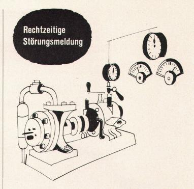
Maschine läuft heiß oder steht still, Temperatur, Druck geht zu hoch oder zu tief, Wasserstand steigt oder sinkt unter Norm. Hier übermittelt das SIGNAPHON bis zu sieben verschiedene Störungsarten innert Sekunden automatisch durch das Telephon an zwei Pikettstellen.
