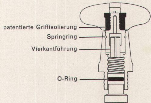
Der Sterngriff ist gegen thermische Einflüsse isoliert. Einfachste Montage und Demontage. Der Griff sitzt mit dem Springring absolut fest, kann aber, wenn nötig, ohne Werkzeug herausgezogen werden. Der bewährte O-Ring garantiert eine einwandfreie Abdichtung; er verhindert das Wegspülen des Fettes und verhütet den Kalkansatz im Spindelgewinde. Sämtliche Auslaufhähnen und Batterien werden im Rahmen des Fabrikationsprogrammes mit diesem neuen Oberteil ausgerüstet.
