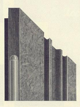
Feinspänig geschlossene Deckschicht Schall- und wärmeisolierend Feuerhemmend Geschlossene und schöne Oberfläche Furnier- und streichfertig Keine Dickendifferenzen
