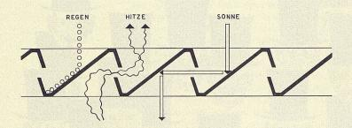
Neue Überdachungsmöglichkeit Leichtmetall für Schaufenstervordächer, Tankstellen, Perrons, und Restaurant-Terrassen. Regenschutz, luftdurchlässig, Brechung der Sonnenstrahlung, einfache Montage
