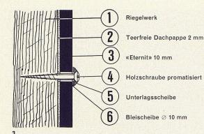
3 Befestigungsdetail der «Eternit»-Platten 1:2, Montageart und Ausführung ist Erfindung von Emil Hauser, Zürich Détail de la fixation des plaques en «Eternit» Detail of the "Eternit" plates' fixations
