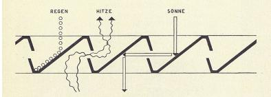
Neue Überdachungsmöglichkeit in Leichtmetall für Schaufenstervordächer, Tankstellen, Perrons, und Restaurant-Terrassen. Regenschutz, luftdurchlässig, Brechung der Sonnenstrahlung, einfache Montage
