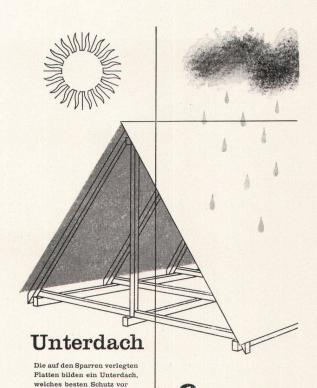
welches besten Schutz vor eindringender Nässe, Flugschnee, Staub sowie Feuerübergriff gewährleistet. Die grossformatigen und leichten Platten gestatten eine einfache und rasche Verlegung.
