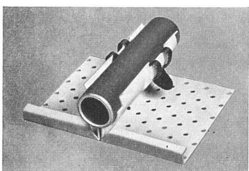
Die ZENT-FRENGER-Decke – nicht mit anderen Heizungs-Systemen zu vergleichen – besteht aus warmwasserdurchflossenen, an der Decke frei aufgehängten Rohrregistern, an denen Aluminiumplatten befestigt sind, wie nebenstehendes Bild veranschaulicht.
