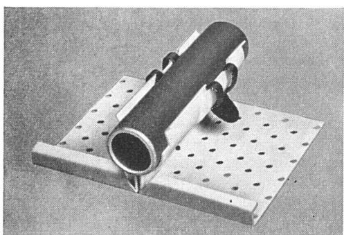
Die ZENT-FRENGER-Decke – nicht mit anderen Heizungs-Systemen zu vergleichen – besteht aus warmwasserdurchflossenen, an der Decke frei aufgehängten Rohrregistern, an denen Aluminiumplatten befestigt sind, wie nebenstehendes Bild veranschaulicht.
