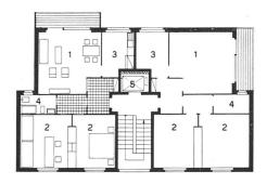
Grundriß des Turmhauses 1:300 | Plan d'un immeuble-tour Typical floor plan of a point house
