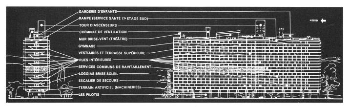
Orientierende Quer- und Längsschnitte | Coupes d'orientation, transversale et longitudinale | Diagrammatic cross-sections
