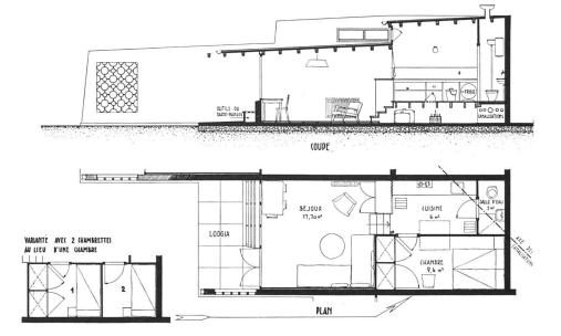
Grundriß 1:150; links Variante mit zwei Schlafkojen / Plan / Groundfloor plan; at l., alternative with two bedrooms
