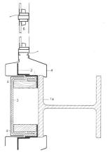
Horizontalschnitt Stütze 1:10 | Coupe horizontale | Horizontal cross-section
