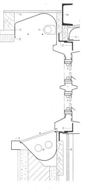
Vertikalschnitt Fenster 1:10 Coupe verticale de la fenêtre Vertical cross-section
