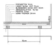
Detail Dach 1:20 | Déte toiture | Roof detail
