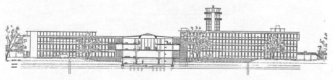
Querschnitt Passagierhallen und Rückfassade Hauptgebäude 1:1000 | Coupe des halls des passagers et façade est | Cross-section of passengers' halls and east elevation
