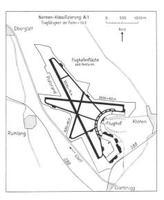
Ausgeführtes Hartpistensystem ohne berollbare Rasenflächen, groβe Pisten in nur drei Richtungen | Le système des pistes | The runway system
