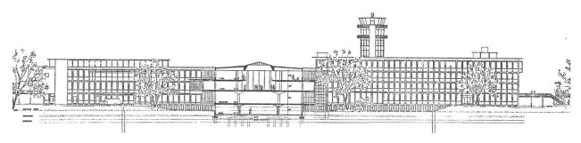
$Querschnitt\ Passagierhallen\ und\ R\"uckfassade\ Hauptgeb\"aude\ 1:1000\ |\ Coupe\ des\ halls\ des\ passagers\ et\ façade\ est\ |\ Cross-section\ of\ passengers'\ halls\ and\ east\ elevation$
