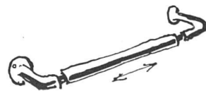
41. Kontaktschalter für automatische Türen, als Zugabschlüsse in Verbindungsgängen, ausgebildet als horizontale Handstange mit verschiebbarem Mittelteil, so daß der Schalter beim Vorbeifahren vom in Fahrt befindlichen Fahrzeug aus leicht bedient werden kann.
