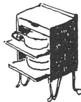
8. Nachttisch aus Holz, mit zwei Füßen mit Rollen und zwei festen Füßen (leicht verschiebbar und trotzdem stabil), genügend großer Schublade (Aktenformat) mit vorderem querliegendem Fach für kleine Gegenstände, wie Uhr, Bleistift, Füllfeder u. a., welche deshalb beim Zuschieben nicht in die Tiefe der Schublade rutschen können. Zwei gutdurchlüftete Abteile mit Klappdeckel, für Bettchüssel, Urinflasche, Waschschüssel, Hausschuhe und dergleichen. Der bettlägerige Patient kann, dank der Abstellfläche, welche der geöffnete Klappdeckel bildet, Schüsseln und anderes ohne Mühe selber heraus- und hineinschieben. Alle horizontalen Flächen sind mit grünem Textolite oder Formica abgedeckt.
