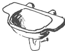
27. Kleinwaschtisch, als platzsparendes Modell für Abortvorplätze, Kabinen usw. Angeformte Konsolen zur Montage mit Abstand von der Wand, zwecks leichter Reinigung. Genügend große angeformte Seifenschalen. (Kerawerke AG, Laufenburg.)
