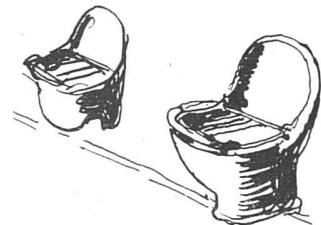
29. Ausgüsse für Wand- und freistehende Montage, mit hochgezogener Rückwand als Wandschutz; Spülrand um Becken und Rückwand. Für sich aufklappbarer Rost, welcher auf einer ebenfalls aufklappbaren Holzschutzleiste aufliegt und gute Reinigungsmöglichkeit des bloßen Keramikkörpers und von Schutzleiste und Rost bietet. (AG für keramische Industrie, Laufen.)
