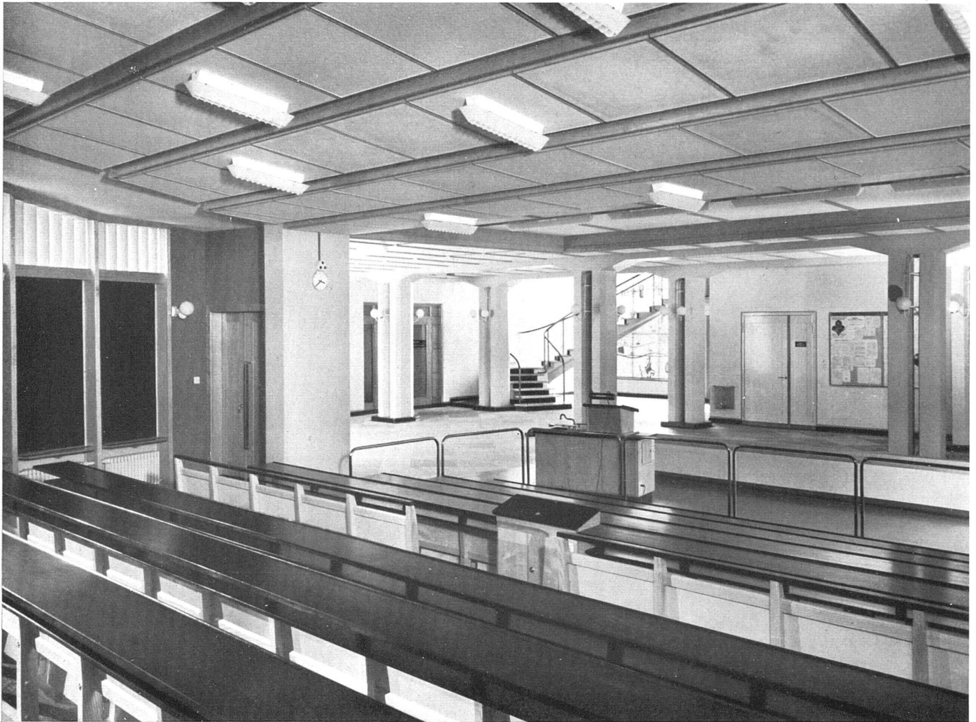
Hörsaal (Kurssaal) mit 100 Sitzplätzen. Der Raum kann durch Versenken der Wände l. und r. und hinter dem Vortragspult (Abbildung) mit der Vorhalle des großen Hörsaals zusammengeschlossen werden (so können z. B. Bettenpatienten von der Halle aus an Veranstaltungen wie Gottesdienst teilnehmen) | Salle de cours de 100 places assises. La salle peut être ouverte vers le hall au moyen d'un système de parois à coulissement vertical (v. reproduction) | Auditorium with a seating capacity of 100. Some parts of the walls can be sunk in the basement, thus the auditorium and the hall become one room
