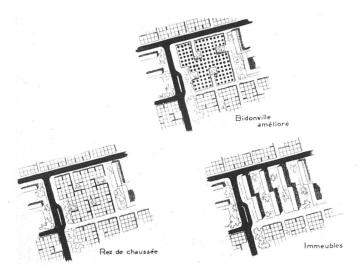
Die drei Stadien der Realisation eines Geviertes | Les 3 étapes de la réalisation d'un secteur | The 3 stages of construction of a typical section
