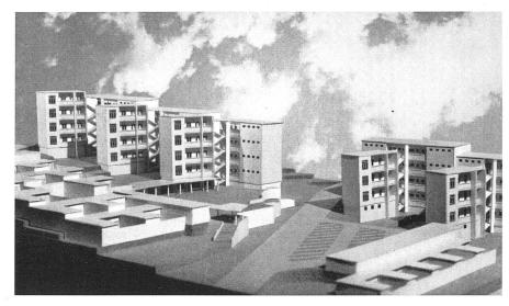
Modellansicht von Südosten | La maquette, vue prise du sud-est | The model, from the south- east. Zentraler Platz durch Rampe und Treppe erreichbar mit Läden, östlich davon Erdgeschoßbauten von traditioneller Form. Westlich des Platzes längs einer Grünzone die mehrgeschossigen Mietbauten. Garagen um den Parkplatz zentralisiert
