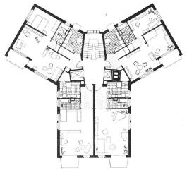
$Variante\ Wohnungsgescho\beta,\ erm\"{o}glicht\ durch\ Skelett-konstruktion,\ 1:400\ |\ Variante\ |\ Variation\ of\ floor\ plan$
