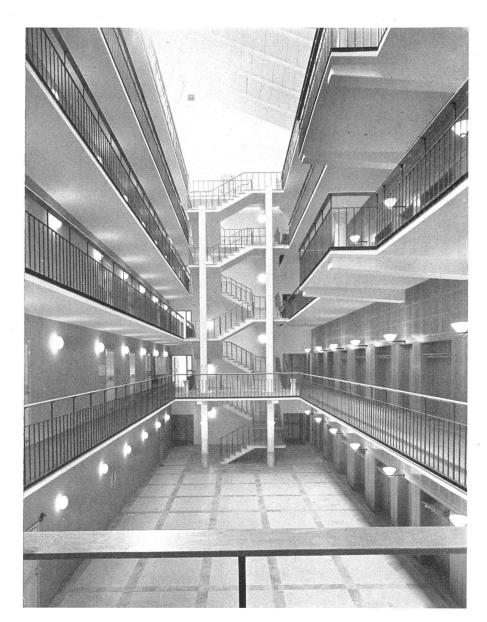
Lichthof mit Treppe und Galerien. Decke aus perforierten Eternitplatten mit dahinterliegenden schallabsorbierenden Steinwollmatten. Boden in Kunststeinmosaik zwischen Marmorfriesen | Cour vitrée, escalier et galeries | Couvered court with staircase and galleries
