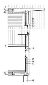
Schnitt durch Außenwand 1:100 | Coupe du mur extérieur | Crosssection of outer wall
