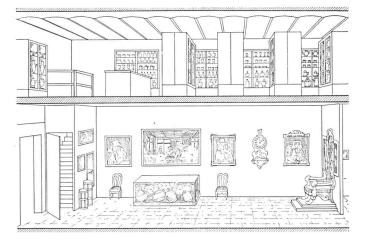
Schnitt durch eine Partie des Westflügels. Durch Einziehen eines Zwischenbodens wurde über dem Berner Standessaal der Studienraum für die Fayence-Sammlung geschaffen | Coupe partielle de l'aile ouest. Un plancher supplémentaire a permis de loger au-dessus de la salle de l'Etat la collection des faïences | Section through part of the west wing. By the inclusion of an intermediate floor the study room for the faïence collection was constructed above the Bernese magisterial hall
