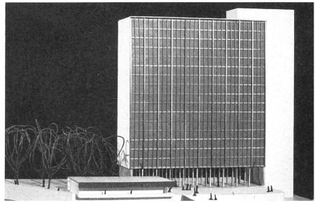
Geschäftshaus. Stahlskelettbau mit äuβerer eloxierter Aluminiumverkleidung | Immeuble de bureaux, façades en aluminium, squelette en acier | Model of an office building, steel skeleton construction, exterior finish with anodysed aluminium
