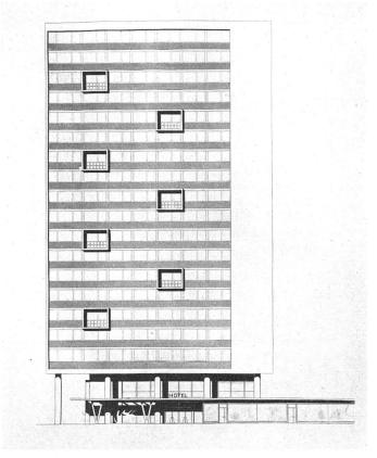
Projekt für ein Hotel, Fassadenstudie. Brüstungen mit blauen Keramikplatten verkleidet | Projet d'hôtel, étude de façade, les parapets recouverts de carreaux de céramique bleue | Project for a hotel, elevation, the parapets being clad with blue ceramic tiles
