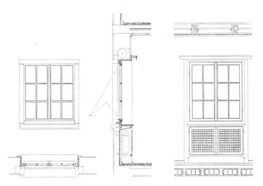
Detail eines Fensters mit Rolladen (1:10) | Détail d'une fenêtre avec store à roulaux | Window detail with rolling shutters
