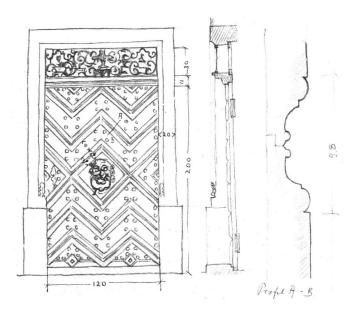
$Aufnahme\ einer\ alten\ T\"ure\ |\ Relev\'e\ d'une\ vieille\ porte\ |\ Sketch\ of\ an\ old\ front\ door$
